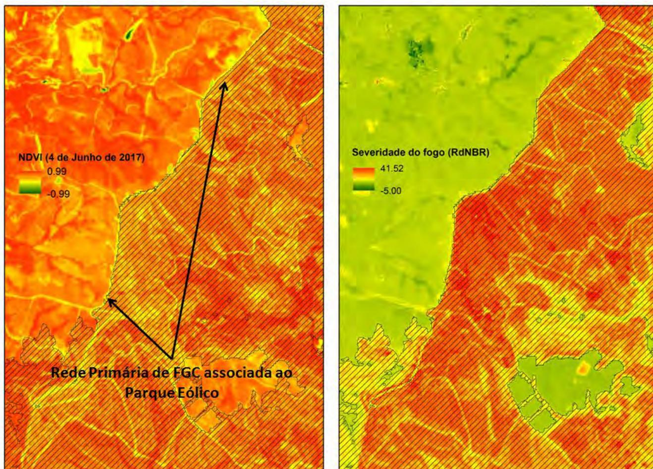
**Figura 7.3** Efeito da faixa associada ao Parque Eólico situado na interface dos municípios de Penela e Figueiró dos Vinhos e identificada no PMDFCI de Penela como Rede Primária de FGC.
